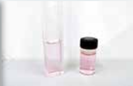
残留塩素濃度の検査（塩素に反応し、ピンク色に染まる薬品を使用）
