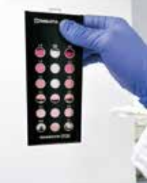
残留塩素濃度の検査（塩素に反応し、ピンク色に染まる薬品を使用）
