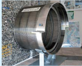
集水管の実物大模型 (江山浄水場展示)
