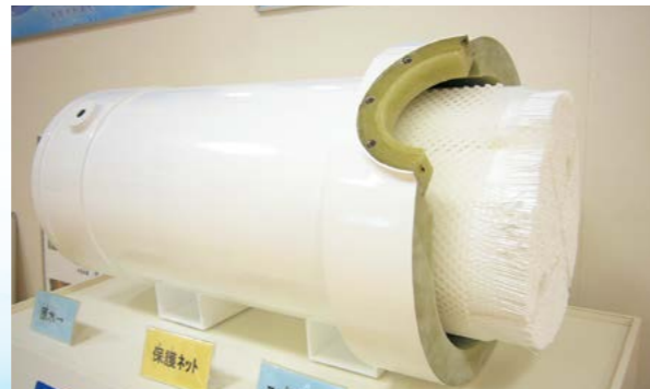
膜モジュールのカットモデル…この中に入っているたくさんの中空糸膜1本1本に原水を流し込みます。
