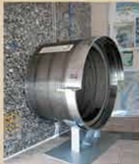
集水管の実物大模型 (江山浄水場展示)
