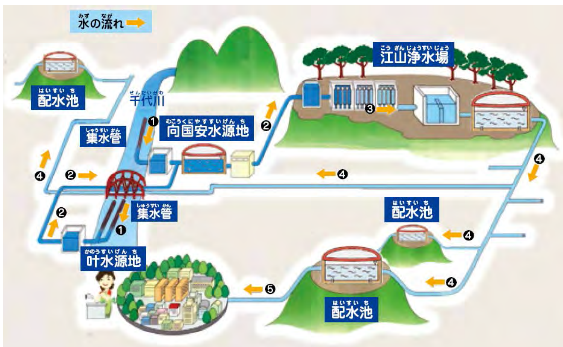
図 2.33 水道システムでの水の流れ（鳥取・国府地域）
