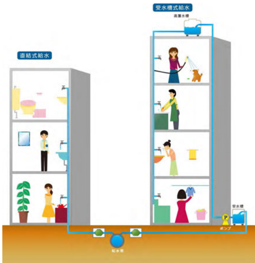
図 2.18 直結式給水と受水槽式給水
